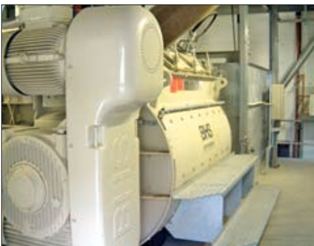
Der Doppelwellen-Mischer BHS hat ein Volumen von 5.250 l und bringt 3,5 m 3 Festbetonleistung pro Charge
